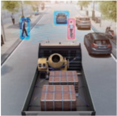
Antikollisjonssystem 02) med fotgjengervarsling* Ved hjelp av radar og et kamera er systemet designet for å oppdage andre kjøretøy og fotgjengere* og kan varsle deg om en potensiell kollisjon. (Ekstraustyr)
